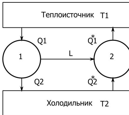
Пусть машина 1 забирает у теплоисточника теплоту  $Q_1$ , отдает в холодильник теплоту  $Q_2$ , производит работу  $L = Q_1 - Q_2$  и имеет термический КПД  $\eta_1 = \frac{T_1 - T_2}{T_1}$ .
