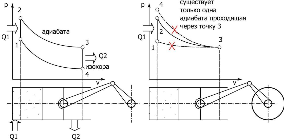
Согласно формулировке Планка нельзя, получив теплоту из некоторого резервуара, превратить ее в работу и не отдавать часть полученной теплоты в резервуар с более низкой температурой вернуться к исходным параметрам рабочего тела (**не существует адиабатного процесса 3-1**). Из формулировки Клаузиуса следует, что невозможно передать теплоту к высокотемпературному источнику, без каких-либо дополнительных условий (**не существует адиабатного процесса 3-4**).
