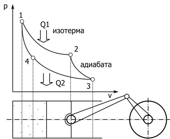
Цикл Карно представлен на рисунке в виде кругового процесса 1-2-3-4-1. Этот цикл состоит из адиабат 2-3 и 4-1 и изотерм 1-2 и 3-4. Физическая картина явлений может быть представлена следующим образом.
